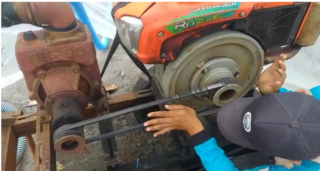
Gambar 7. Mesin pompa berbahan bakar diesel yang saat ini digunakan petambak garam di Desa Patutrejo untuk menarik air dari laut menuju tambak garam di pantai (Foto: Wahyu Anjarjati 2021).
